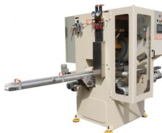
Presse-mouleuse verticale et son moule « à cracher »
