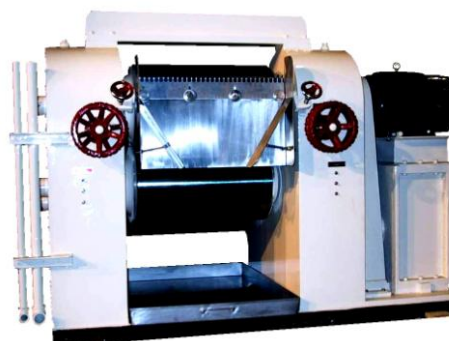
Broyeur tri cylindres ( vue de dos )
